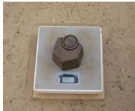
Il est recommandé d'utiliser une planche en bois pour stabiliser la balance au sol.
